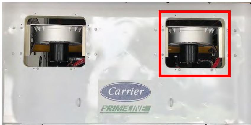
Figure 7.22 Dépose du moteur de l'évaporateur
